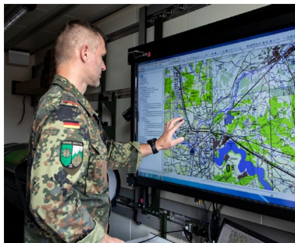
Abbildung 17 Touchscreens mit GIS-Funktionalität zur Einweisung in das Gelände (Quelle: Bundeswehr / Martina Pump)
