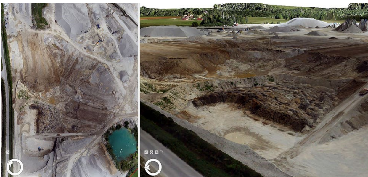
Abbildung 13 Aus einem Luftbild wurde in Verbindung mit dem digitalen Oberflächenmodell (DOM) eine ergänzende 3D-Ansicht erzeugt.
